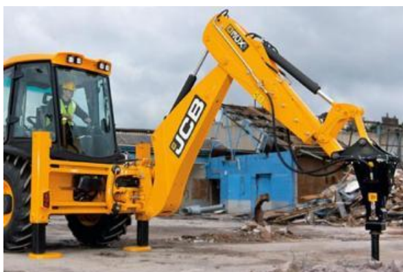
Рисунок 11: Пример гидравлического молота, установленного на экскаваторе-погрузчике типа JCB.
